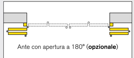
Il pacchetto delle ante può essere posizionato in luce oppure oltre luce, inoltre è possibile in alcuni casi fare compiere allo stesso una rotazione che gli permette di allinearsi al muro.
